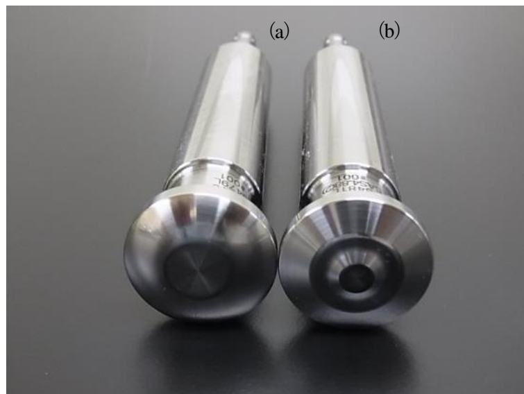
Figure 21 International タイプの標準杵 (a) 及び 2 段タイプ SAS 杵 ® (b) の写真 ( J. Pharm. Sci. 2014 ,103, 1921-1927., Figure 9 より一部改変)
