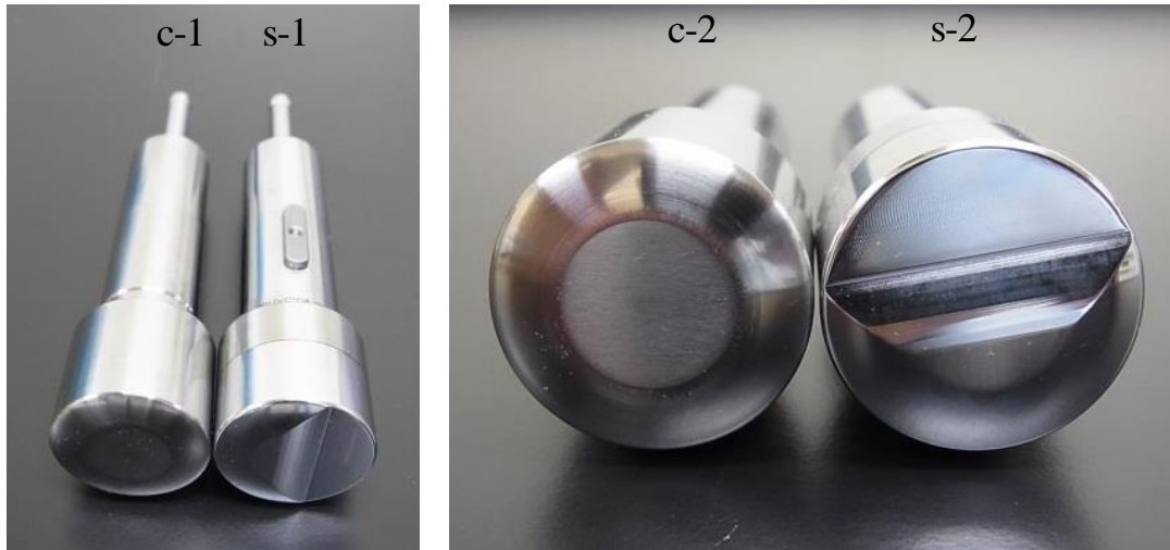
Figure 7 標準杵 (c-1, c-2) と SAS 杵 ® (s-1, s-2) の写真 (J. Pharm. Sci. 2014,103, 235-240., Figure 4)
