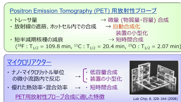
図 1 マイクロリアクターを用いた PET 合成
