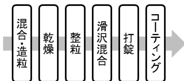
Fig.1 錠剤の各製造工程
